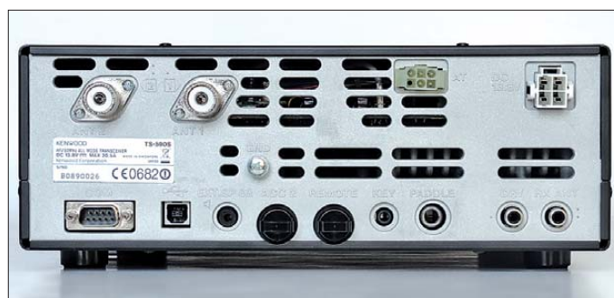
Bild 5: Rückansicht des TS-590S; vierpolige Stromversorgungsbuchsen repräsentieren inzwischen den Standard. Die erhabenen angebrachten Bezeichnungen sind nur schlecht lesbar. Auf den DIN-Buchsen stecken Schutzkappen.
