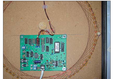
Bild 3: Rückseite der Polarkoordinatenkarte mit VBI-Controllerplatine und spinnennetzartiger Verdrahtung zu den 72 Leuchtdioden
