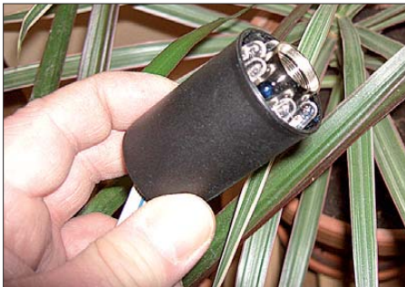
Bild 1: Ansicht des einfachen LED-Spektroskops in einer leeren Filmdose
