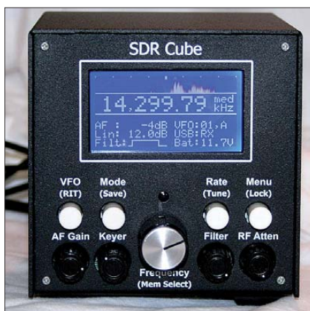
Dieser SDR-Transceiver, der SDR Cube, kommt ganz ohne PC aus. Foto: N2APB
