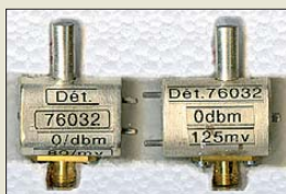
Detektorköpfe für 76 GHz, Ausgangsspannung 125 mV bei 0 dBm Eingangsleistung
