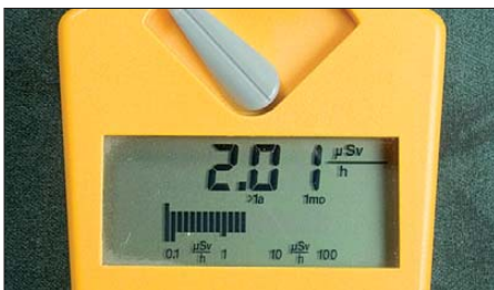
Bild 5: In Betastellung steigt der Messwert durch den Thoriumglühstrumpf deutlich auf das Zehnfache an.
