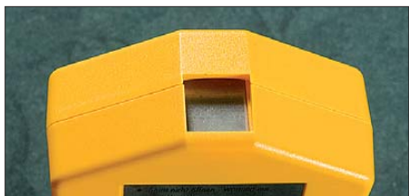
Bild 2: Blick auf Zählrohr in Stellung Gamma-Messung
