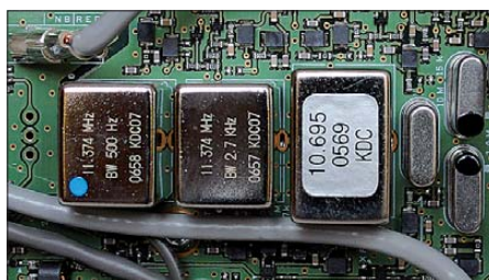
Bild 9: Die Filterbank; links die beiden Roofing-Filter des Doppelsupers, rechts die Filter in der 2. ZF des Dreifachsupers, alle an derselben Stelle des hier schon wieder gemeinsamen Verstärkerzugs
