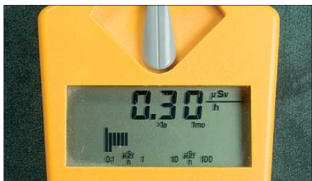
Bild 3: In Gammastellung des Gamma-Scout steigt der Messwert durch den angelegten Thoriumglühstrumpf nur schwach an.
