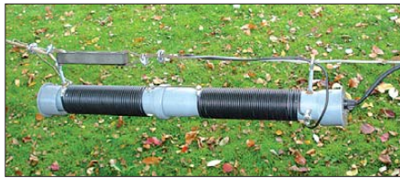
Bild 6: Ansicht von Sperrkreis und Verlängerungsspule; das den Sperrkreiskondensator bildende Koaxialkabelstück hängt rechts heraus.
