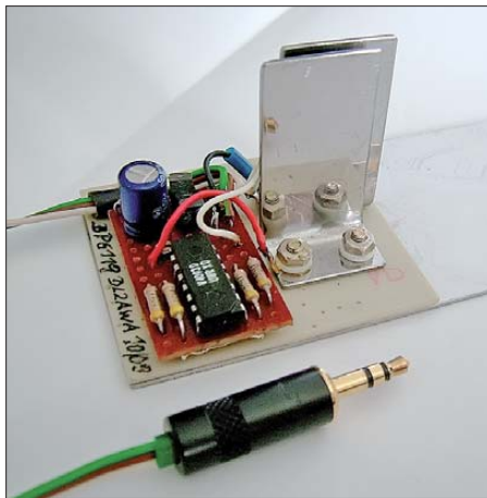
Bild 1: Ansicht des Sensorpaddles; die Betätigungsflächen sind isoliert auf der Grundplatte montiert. Foto: DL2AWA
